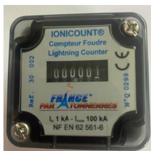
CONTADOR DE DESCARGAS / RAYOS
